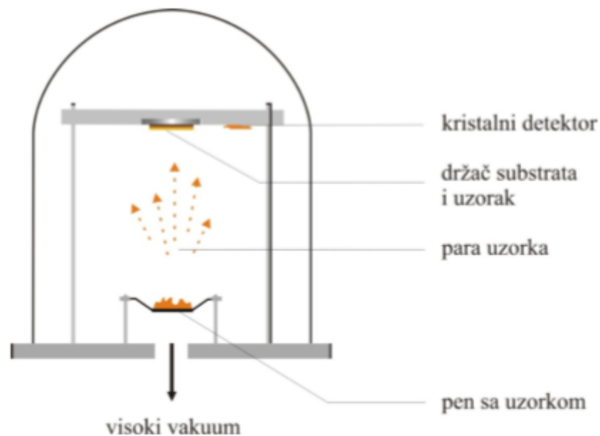
Principijelna šema aparature za termičko isparavanja u vakuumu
