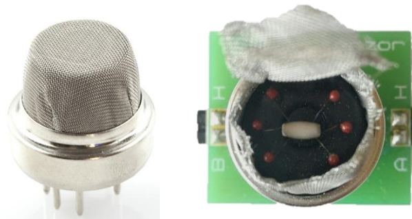
Slika 1 Izgled unutrašnjosti gasnog senzora
